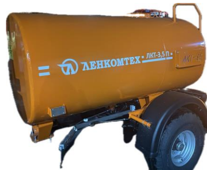
Полуприцеп-цистерна поливомоечный ЛКТ-3,5
